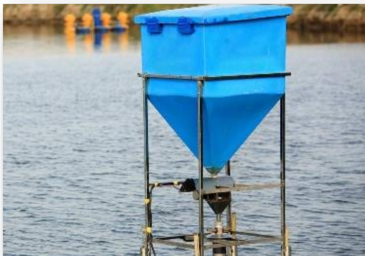
نمونه دستگاه غذاپاش خودکار مورد استفاده در مزارع پرورش میگو
