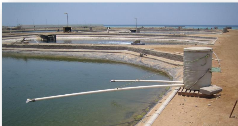
نمونه دستگاه غذایاش خودکار مورد استفاده در مزارع پرورش میگو
