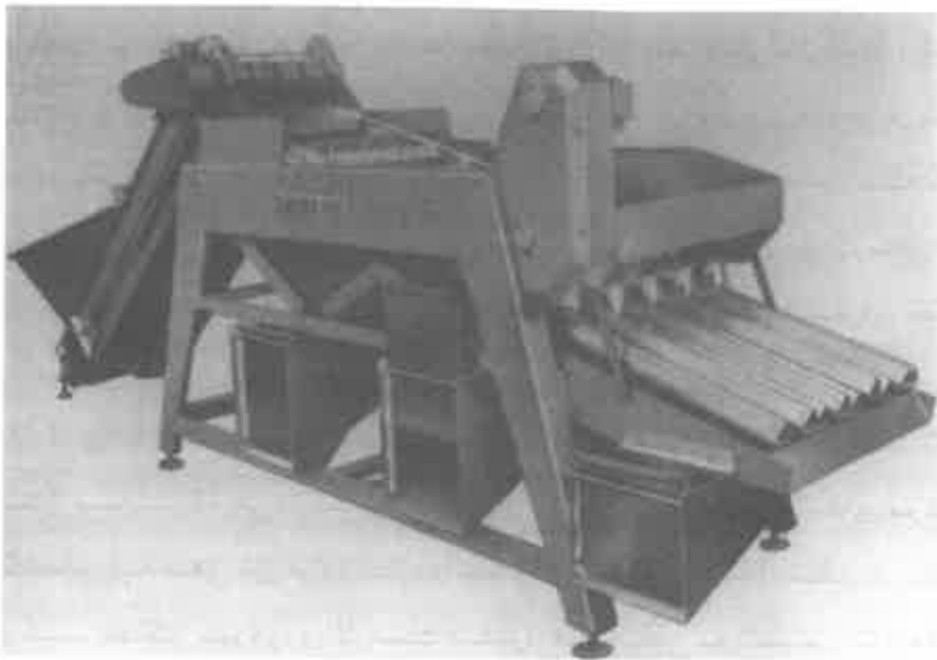
۲-۲- چین دستگاه‌هایی برای دسته بندی اتوماتیک ماهی‌ها، به اندازه‌های مختلف طراحی
